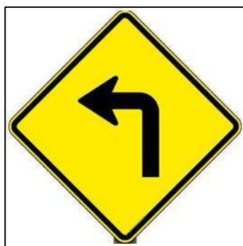
Figura 58 : Sinalização de Advertência - A-1a (Curva acentuada à esquerda).
