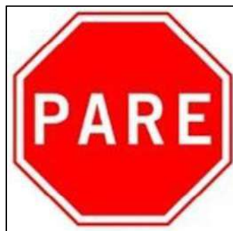
Figura 55 Sinalização de Regulamentação - R-1 (Parada Obrigatória).
